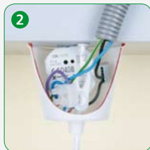
Zabudowa odbiornika w obudowę lampy
